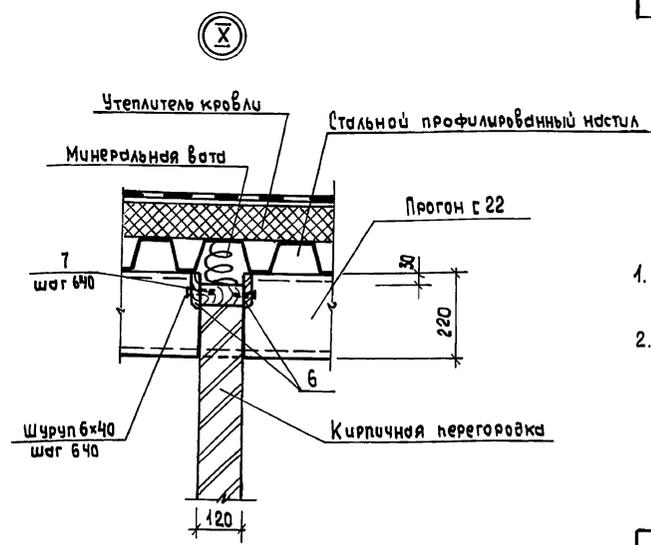
1. Кастыль поз.3 приварить к ригелю с шагом 500 и соединить на болтах с антисептированными деревянными брусом.
