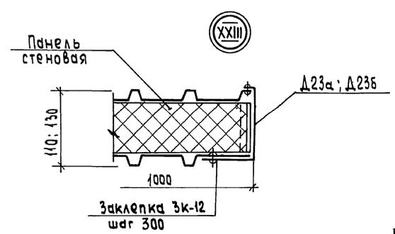
1. Отверстия в стеновых панелях вырезать по месту, рамы РМ4; РМ5 и соединительные изделия МС5÷МС13 установить до монтажа панелей.
