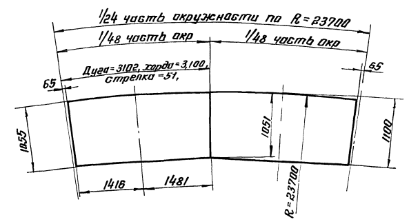
Разбивка элементов опорного кольца.
