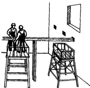
Рис. 24. Вывешивание и распиливание балки
