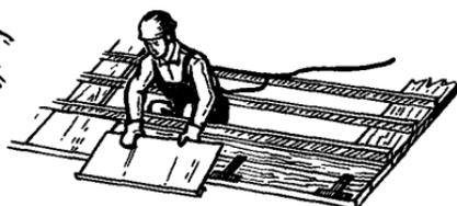
Рис. 16. Разборка карнизного свеса
