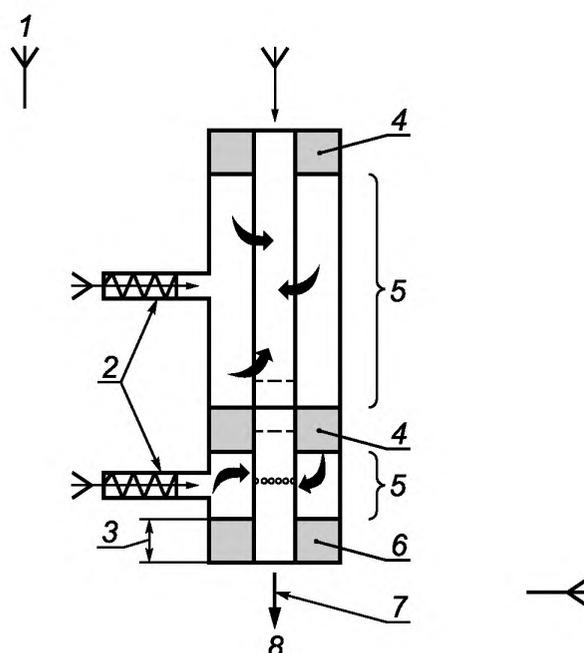
1 — атмосфера испытаний в соответствии с ГОСТ ISO 3402; 2 — устройство для измерения вентиляционного потока; 3 — глубина вставки в соответствии с ГОСТ ISO 3308; 4 — регулируемые разделительные уплотнения; 5 — вентиляционная камера; 6 — фиксированное удерживающее уплотнение; 7 — устройство для измерения сопротивления затяжке сигарет; 8 — общий поток воздуха
