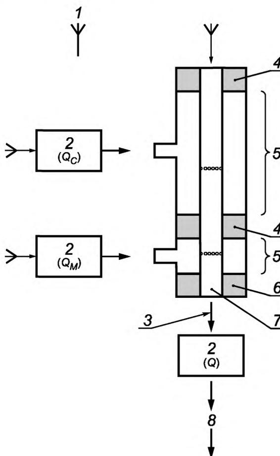
1 — атмосфера в соответствии с ГОСТ ISO 3402; 2 — прибор для измерения объемного потока; 3 — перепад давления ( $\Delta P_Z$ ); 4 — разделительные уплотнения; 5 — вентиляционная камера; 6 — фиксированное удерживающее уплотнение; 7 — выходной конец калибра вентиляции; 8 — общий поток пропускаемого воздуха
