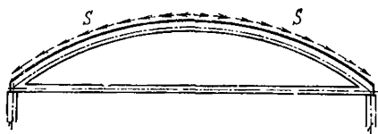
Рис. 4.18. Схема передачи усилий с оболочки на диафрагму
