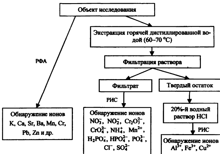
Рис. 28. Аналитическая схема совместного использования методов элементного и химического анализа
