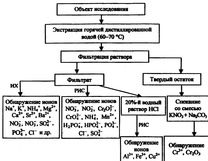
Рис. 30. Аналитическая схема использования химического анализа и ИХ
