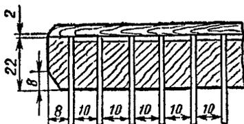
Рис. 7. Проволочные щетки для ручной очистки:
