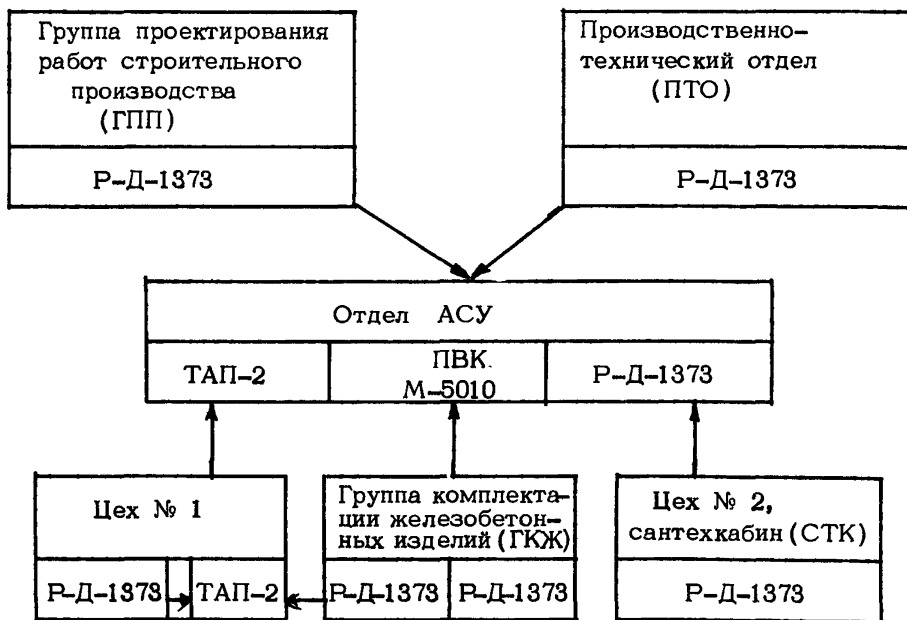
Рис. 2. Схема системы подготовки, передачи и обработки информации
