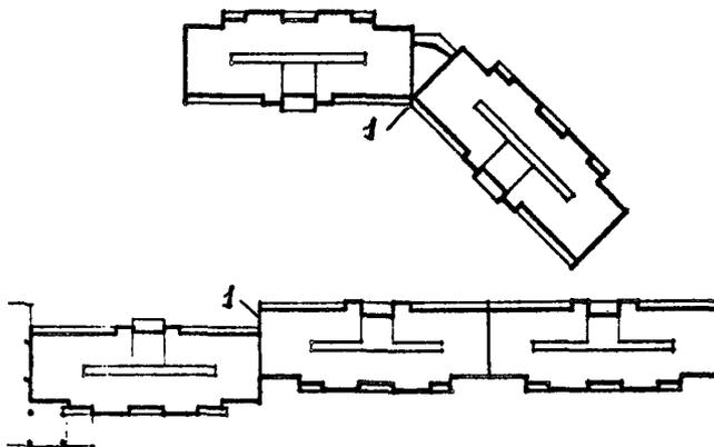
Рис. 2. Примеры расчленения здания сложной формы в плане на отсеки: 1 - деформационный шов
