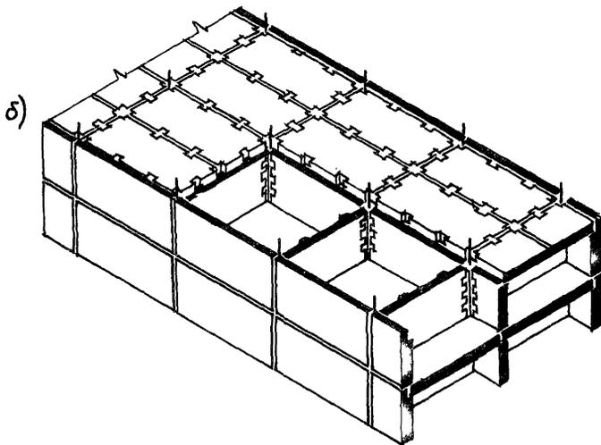
Рис. 1. Конструктивные системы крупнопанельных зданий для сейсмических районов:
