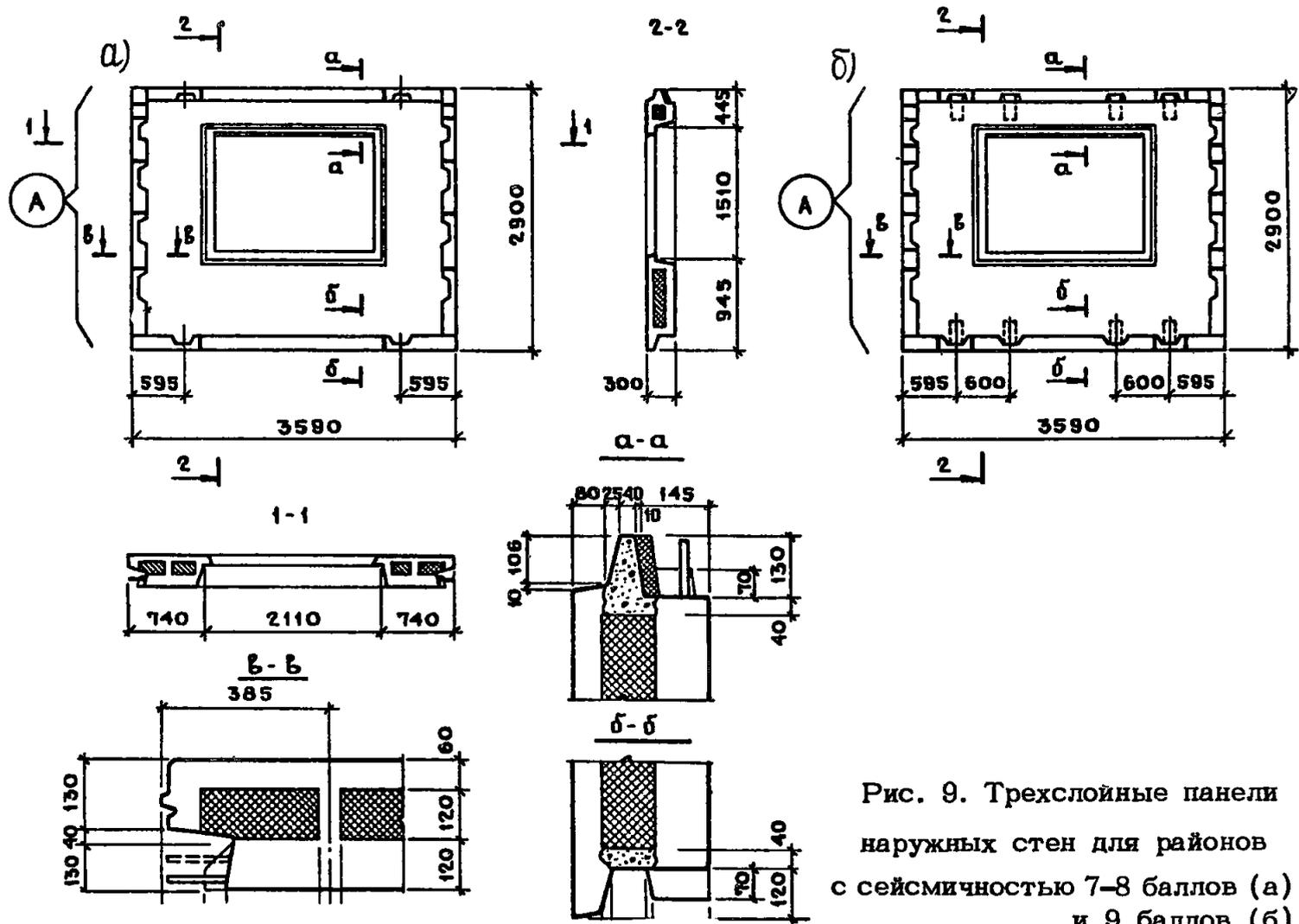
Рис. 9. Трехслойные панели наружных стен для районов с сейсмичностью 7-8 баллов (а) и 9 баллов (б)
