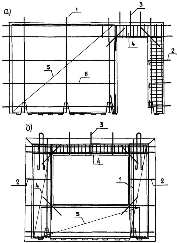
Рис. 12. Схемы армирования стеновых панелей по опыту СРР:
