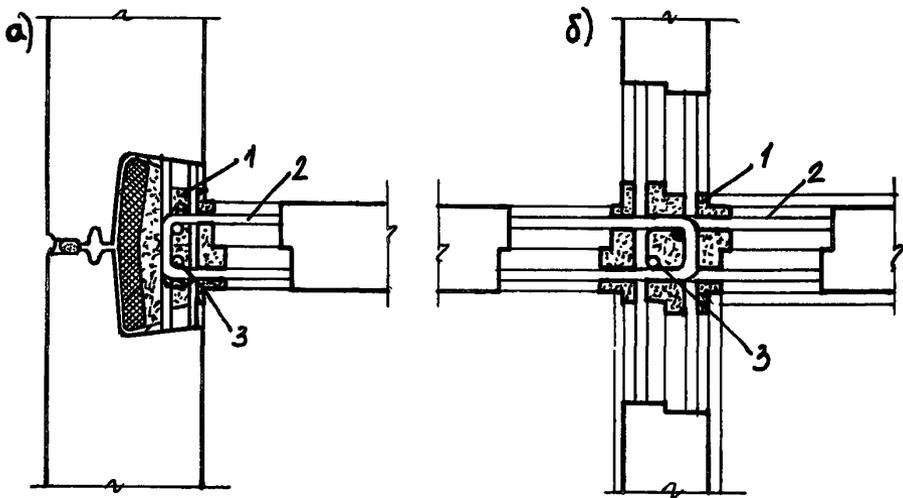
Рис. 17. Петлевые связи в вертикальных стыках наружных (а) и внутренних (б) стен:
