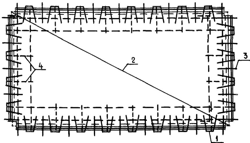
Рис.14. Схемы армирования плиты перекрытия, опирающейся на стены с помощью опорных "пальцев" (опыт СРР):
