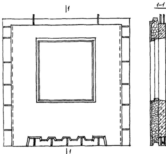
Рис. 10. Двухслойная панель наружной стены
