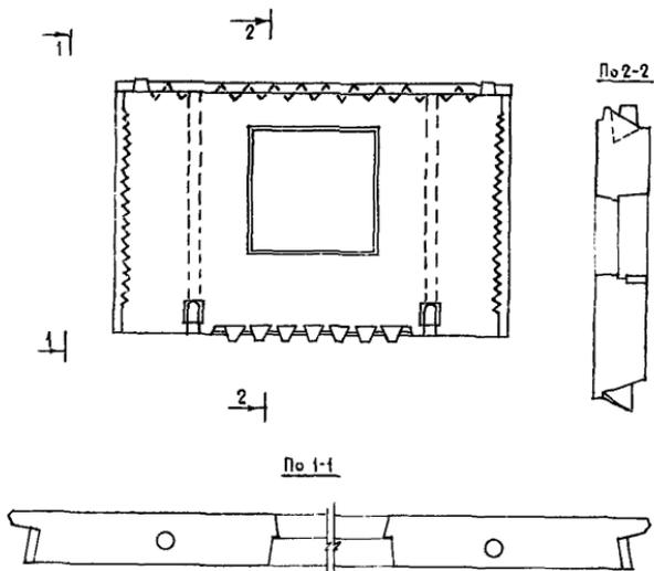
Рис. 11. Однослойная панель наружной стены
