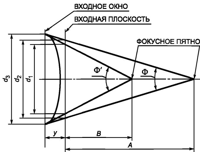
$d_1$  — РАЗМЕР РАБОЧЕГО ВХОДНОГО ПОЛЯ, соответствующий углу  $\Phi'/2$  (т. е. РИВ = В),  $d_2$  — РАЗМЕР РАБОЧЕГО ВХОДНОГО ПОЛЯ, соответствующий углу  $\Phi/2$  (т. е. РИВ = А), см;  $d_3$  — НОМИНАЛЬНЫЙ РАЗМЕР ВХОДНОГО ПОЛЯ УРИ ВО ВХОДНОМ ОКНЕ, см
