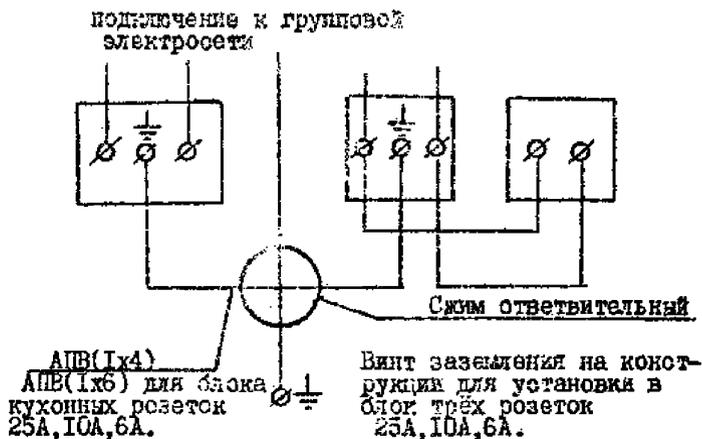
Рис.7. Принципиальная схема подключения кухонного блока розеток
