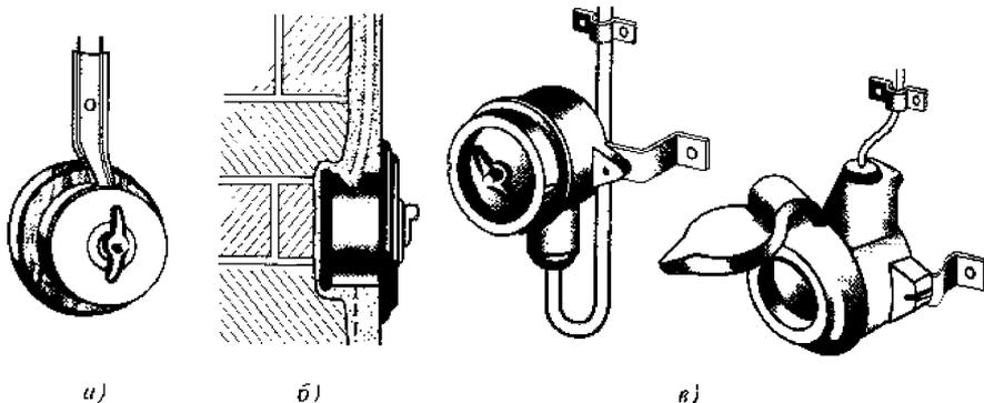
Рис.4. Примеры монтажа установочных приборов:
