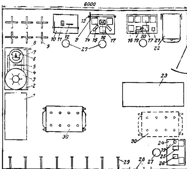
Рис.3. План технологической линии по заготовке электропроводок в жилых домах общей площадью 100 тыс. м<sup>2</sup> в год:
