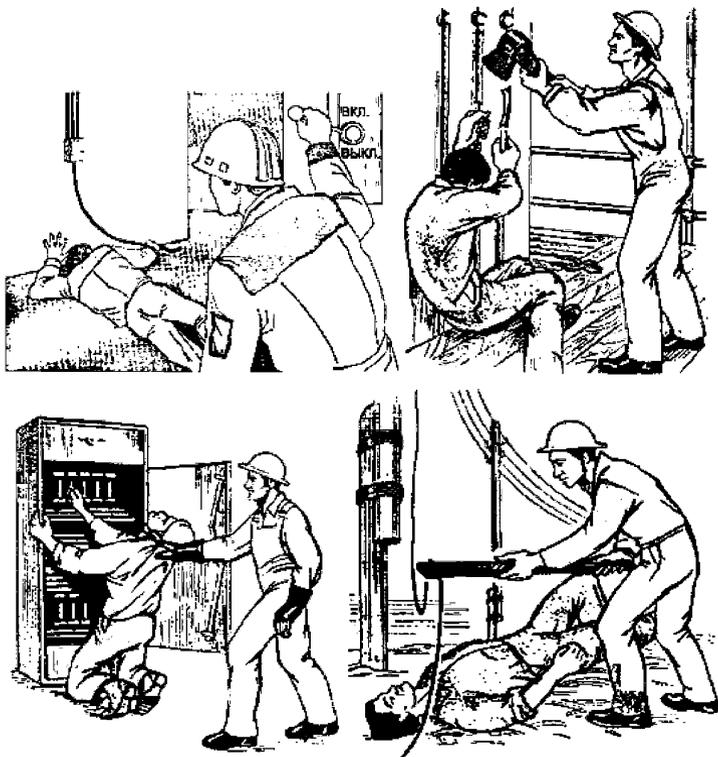
Рис.10. Способы освобождения пострадавшего от действия электрического тока
