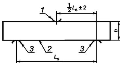
1 — опора для приложения нагрузки (нажимная); 2 — поверхность образца, работающая на растяжение;
