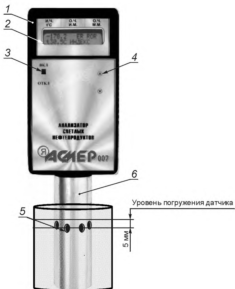
1 — корпус анализатора; 2 — электронное табло; 3 — выключатель питания анализатора; 4 — кнопки управления; 5 — технологические отверстия; 6 — датчик анализатора
