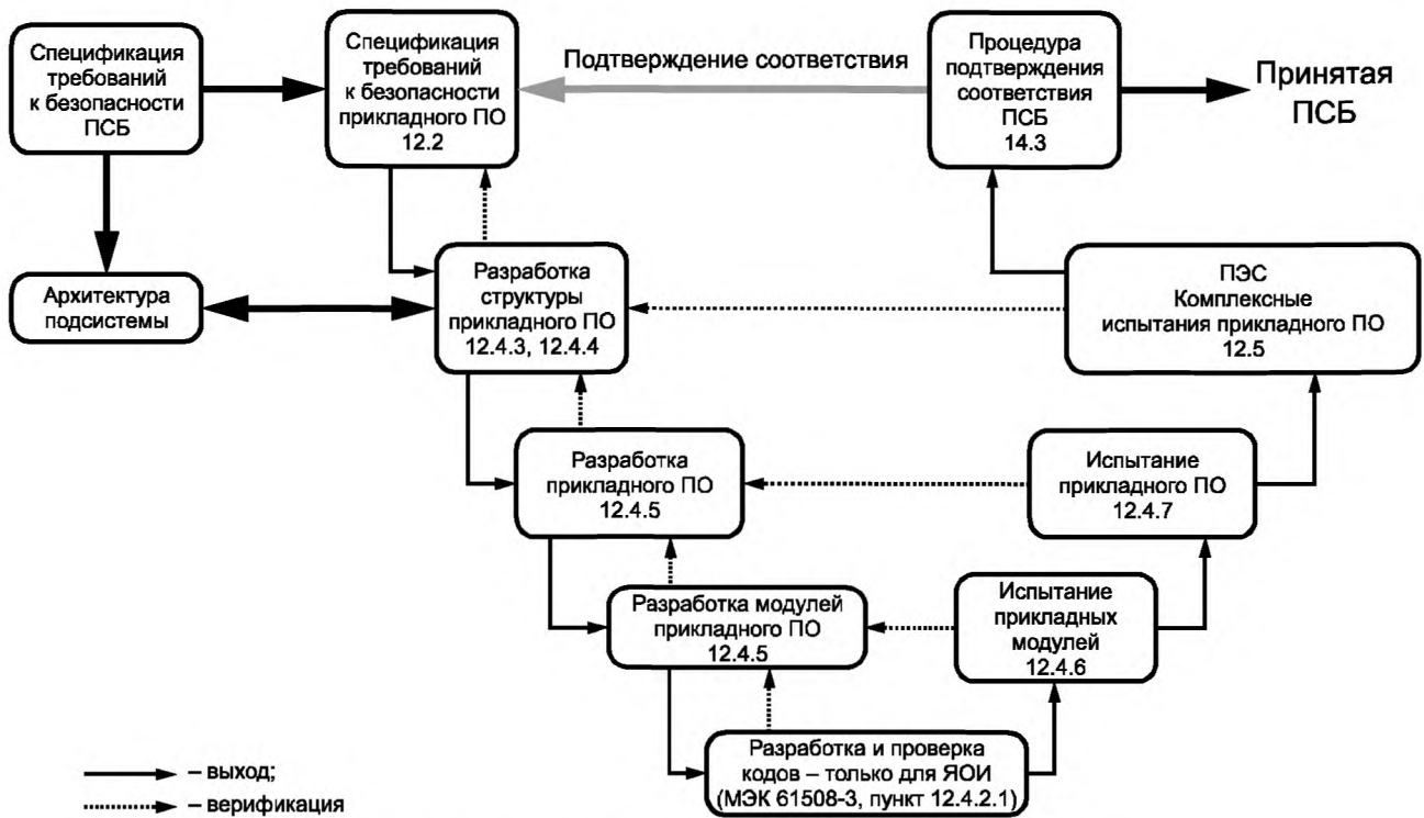
Рисунок 12 — Жизненный цикл разработки ПО (V-образная модель)
