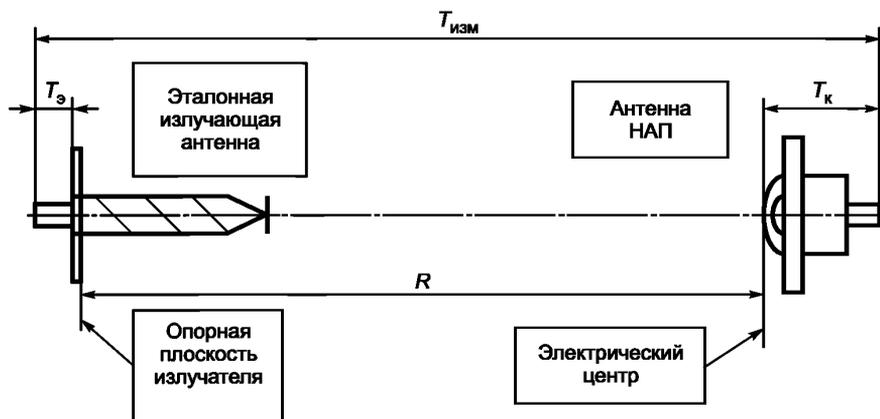
$T_k$  — задержка сигнала в антенне НАП;  $T_э$  — задержка сигнала в эталонной излучающей антенне;  $T_{изм}$  — задержка сигнала между плоскостью разъемов излучающей и калибруемой антенн;  $R$  — расстояние между электрическим центром антенны НАП и опорной плоскостью эталонной антенны
