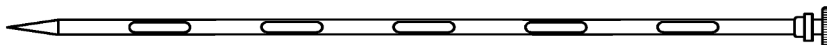
Рисунок В.2 — Открытая труба с несколькими отверстиями или закрытая труба с отсеками и несколькими отверстиями
