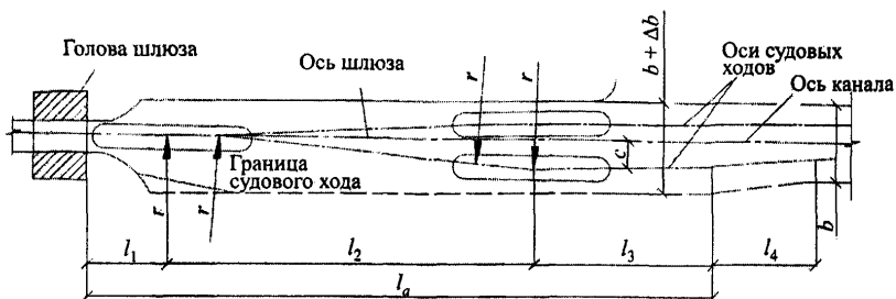
Рисунок Е.2 – Схема очертания в плане подходного канала к шлюзу
