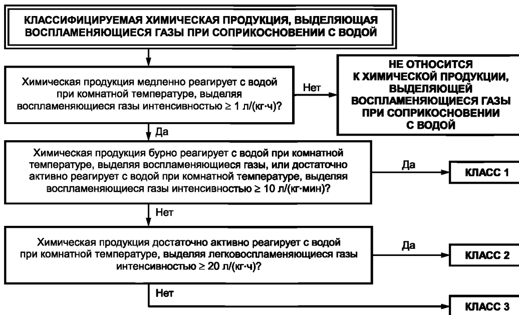
Рисунок 1 — Процедура классификации опасности химической продукции, выделяющей воспламеняющиеся газы при соприкосновении с водой
