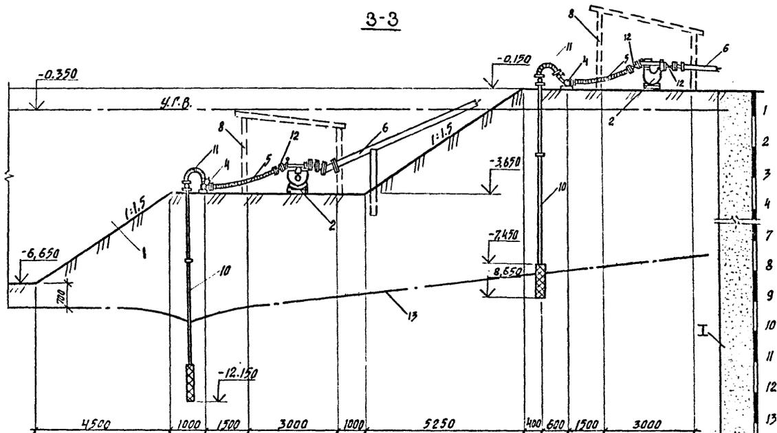
1-котлован; 2-установка ЛУЧ-5; 4-водосборный коллектор  $\phi=150$  мм; 5-всасывающий рукав  $\phi=150$  мм; 6-напорная линия  $\phi=150$  мм; 8-будка; 10-уголфильтр; 11-соединительный шланг; 12-забьжки; 13-депресссионная кривая; (I)-мелкий песок; II-глина
