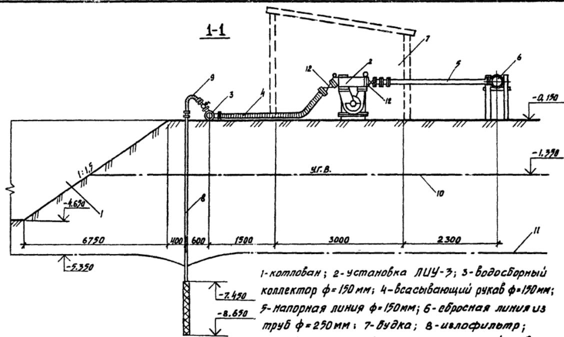
1-котлован; 2-установка ЛЦУ-3; 3-водосборный коллектор  $\phi=150$  мм; 4-всасывающий рукав  $\phi=150$  мм; 5-напорная линия  $\phi=150$  мм; 6-сбросная линия из труб  $\phi=250$  мм; 7-будка; 8-инвентарный фильтр; 9-соединительный шланг; 10 - ч.г.в./уровень грунтовых вод/; 11-депресссионная кривая; 12-задвижки;
