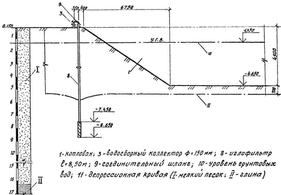
1-котлован; 3-водосборный коллектор  $\phi=150$  мм; 8-излофильтер  $r=8,50$  м; 9-соединительный шланг; 10-уровень грунтовых вод; 11-депресссионная кривая (I-мелкий песок; II-глина)
