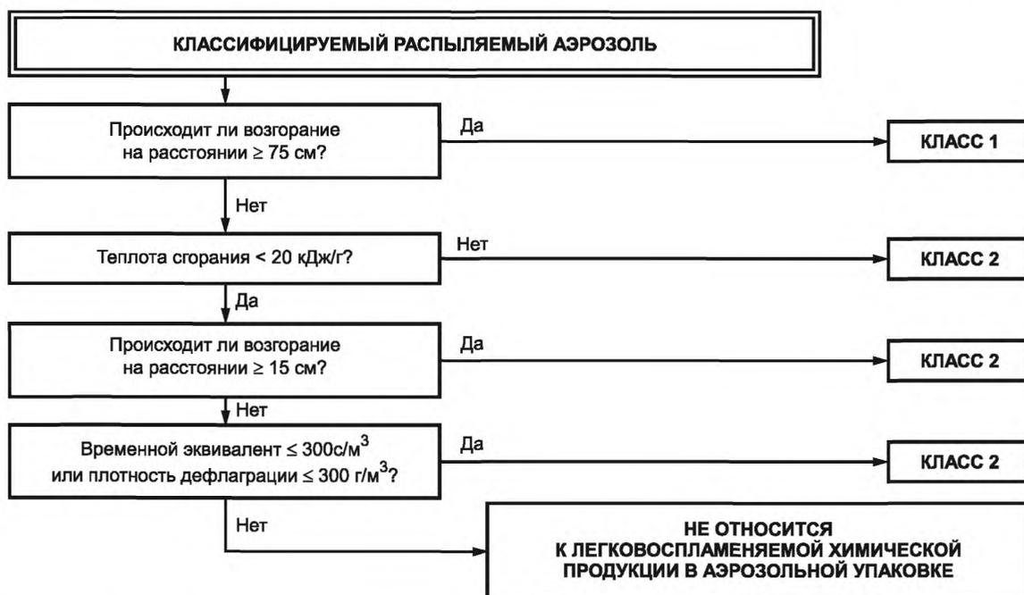
Рисунок 2 — Процедура классификации химической продукции, являющейся распыляемым аэрозолем
