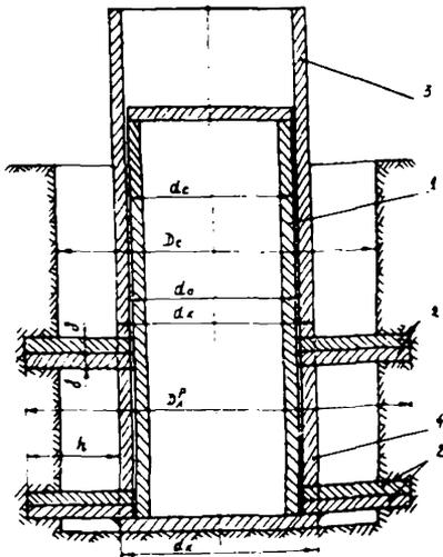
Рис.2. Многолопастная анкерная свая с плоским нижним торцом:
