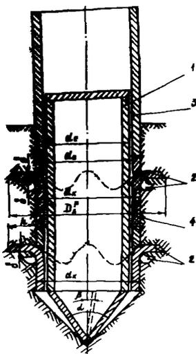
Рис. 4. Многолопастная анкерная свая с заостренным нижним торцом:
