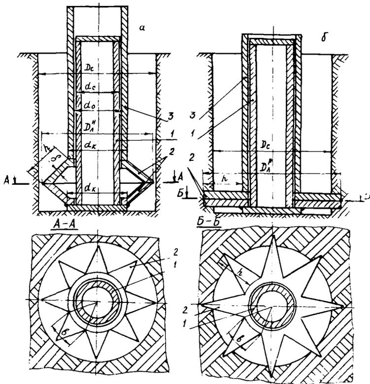
Рис.1. Однолопастная анкерная свая с плоским нижним торцом:
