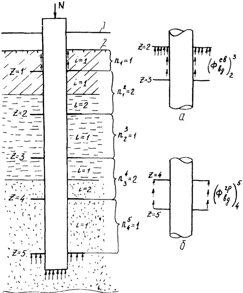
Рис.10. Расчетная схема многолопастной анкерной сваи, работающей на вдавливание:
