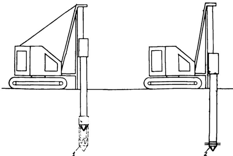
Рис.8. Устройство забивных свай с заостренным нижним торцом:
