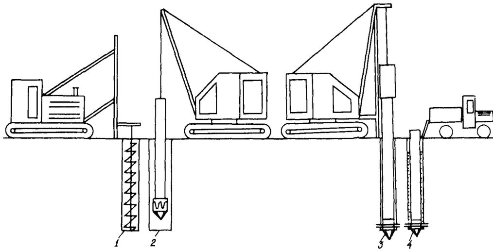
Рис.6. Устройство буропускных свай с заостренным нижним торцом:
