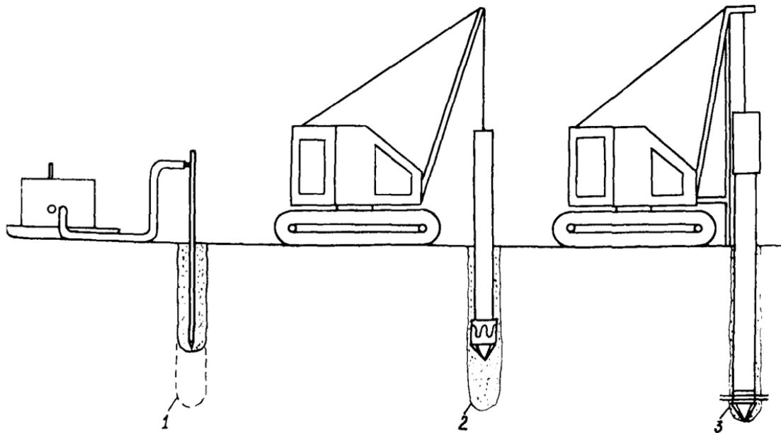
Рис.9. Устройство опускаемых свай с заостренным нижним торцом:
