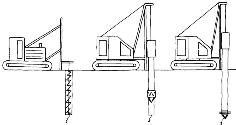
Рис.7. Устройство бурозабивных свай с заостренным нижним торцом:
