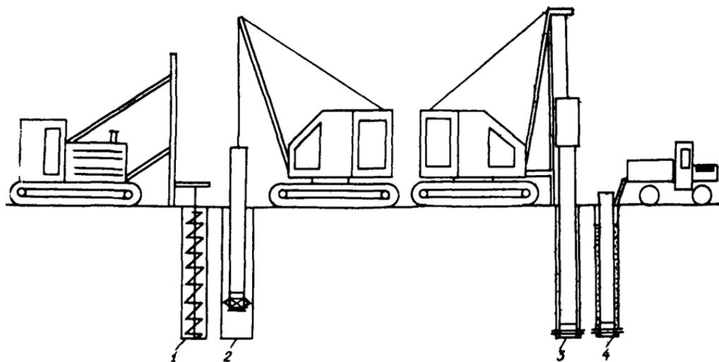
Рис.5. Устройство буропускных свай с заостренным нижним торцом:
