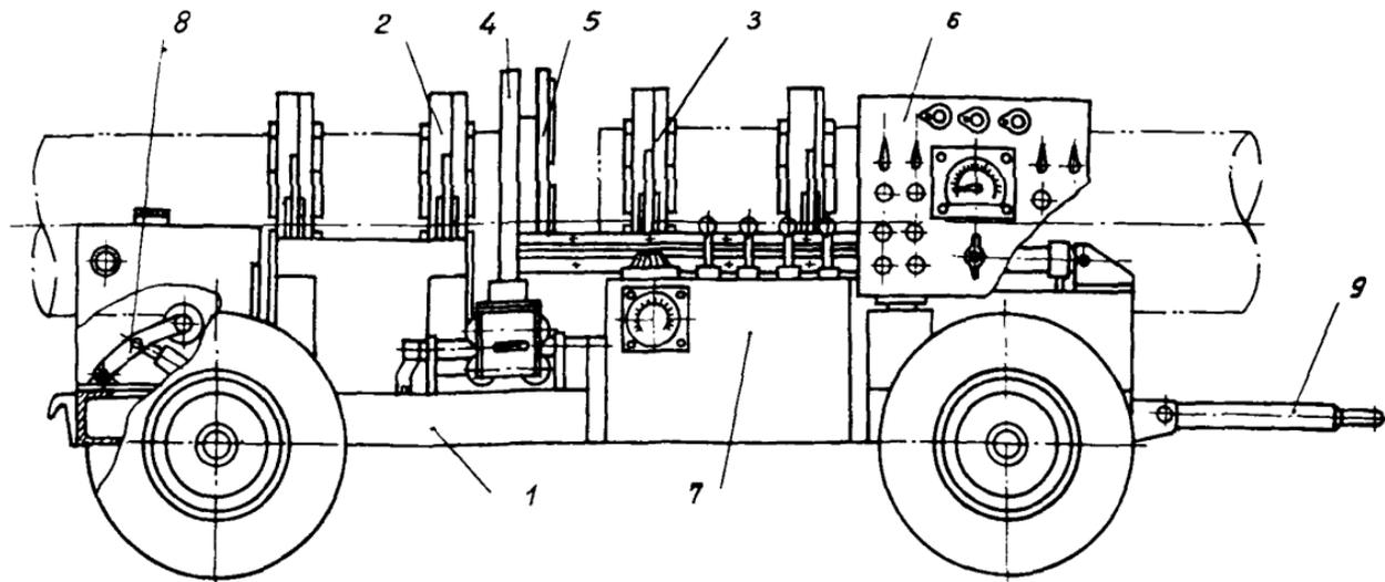
Рис.7. Схема установки УСПТ-7 для контактной тепловой сварки встык пластмассовых труб диаметром 140-355 мм:
