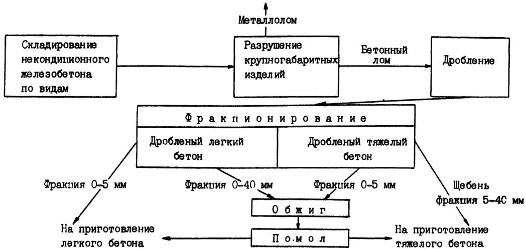
хема технологической линии по комплексной переработке некондиционного бетона и железобетона с использованием активационных методов
