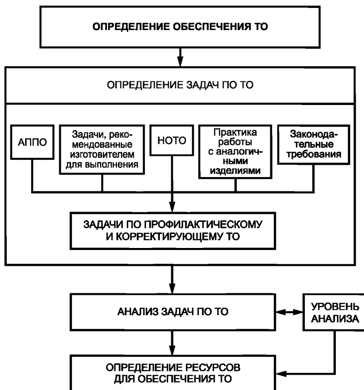
Рисунок 4 — Элементы планирования ТО и обеспечения ТО
