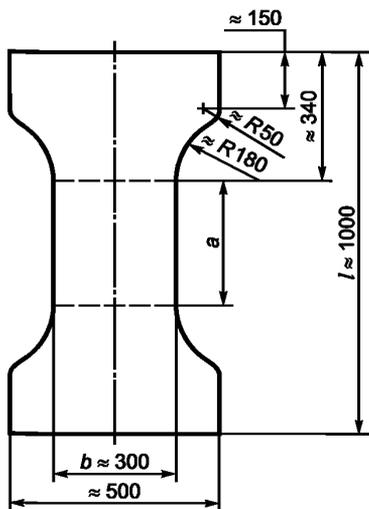
Толщина образцов, предназначенных для испытаний, должна быть равна толщине изделия, из которого они вырезаны, включая толщину обкладки, облицовки и/или покрытия.
