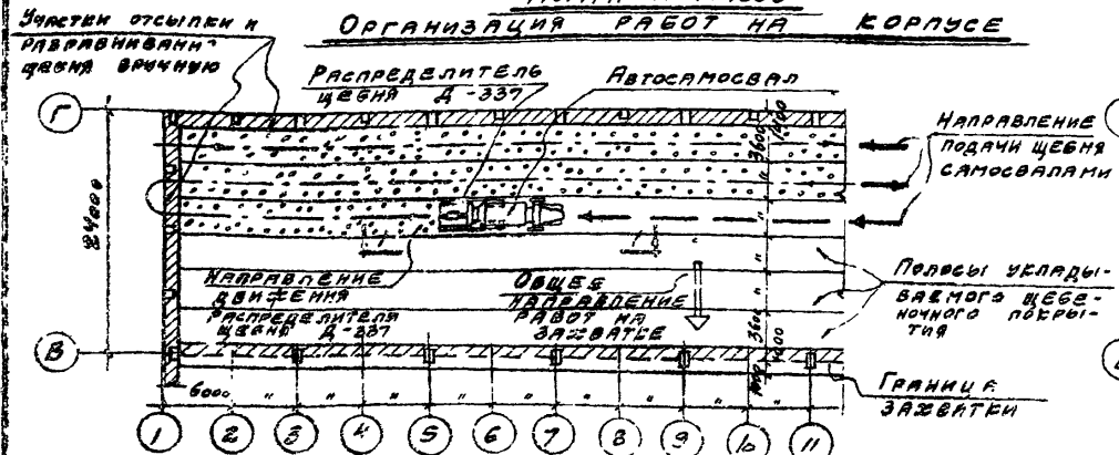
I - этап. Отсыпка щебня, разравнивание и предварительное уплотнение распределителем щебня Д-337
