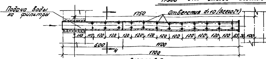
План по Г-Г Двухканальная труба фильтра d=80 (15шт.)
