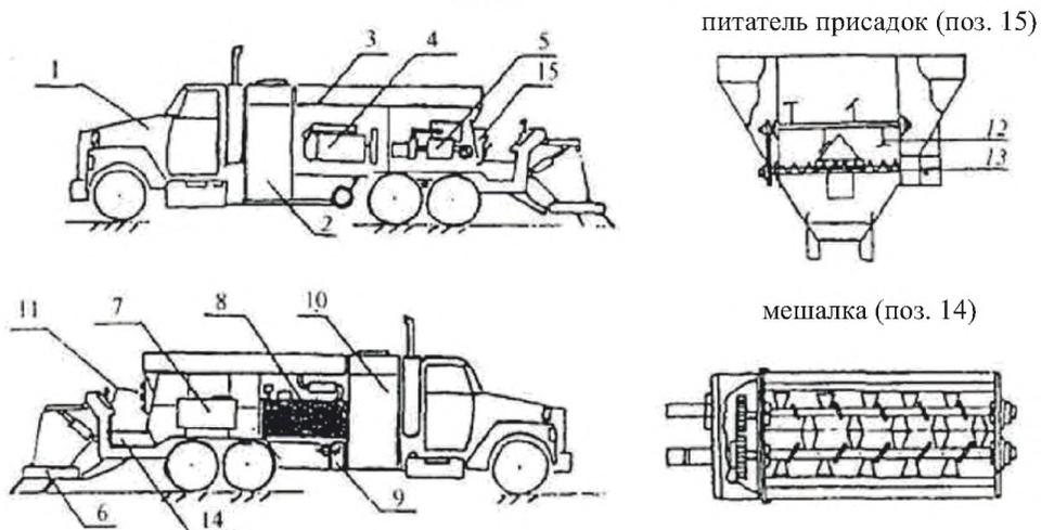
1 – тягач; 2 – бак для эмульсии; 3 – бункер минеральных материалов; 4 – двигатель силовой установки; 5 – гидромотор; 6 – навеска (распределительный короб); 7 – бак раствора сульфата алюминия; 8 – масляный бак; 9 – водяная помпа; 10 – бак для воды; 11 – пульт управления; 12 – мешалка лопастная; 13 – шнековый дозатор; 14 – мешалка; 15 – питатель присадок
