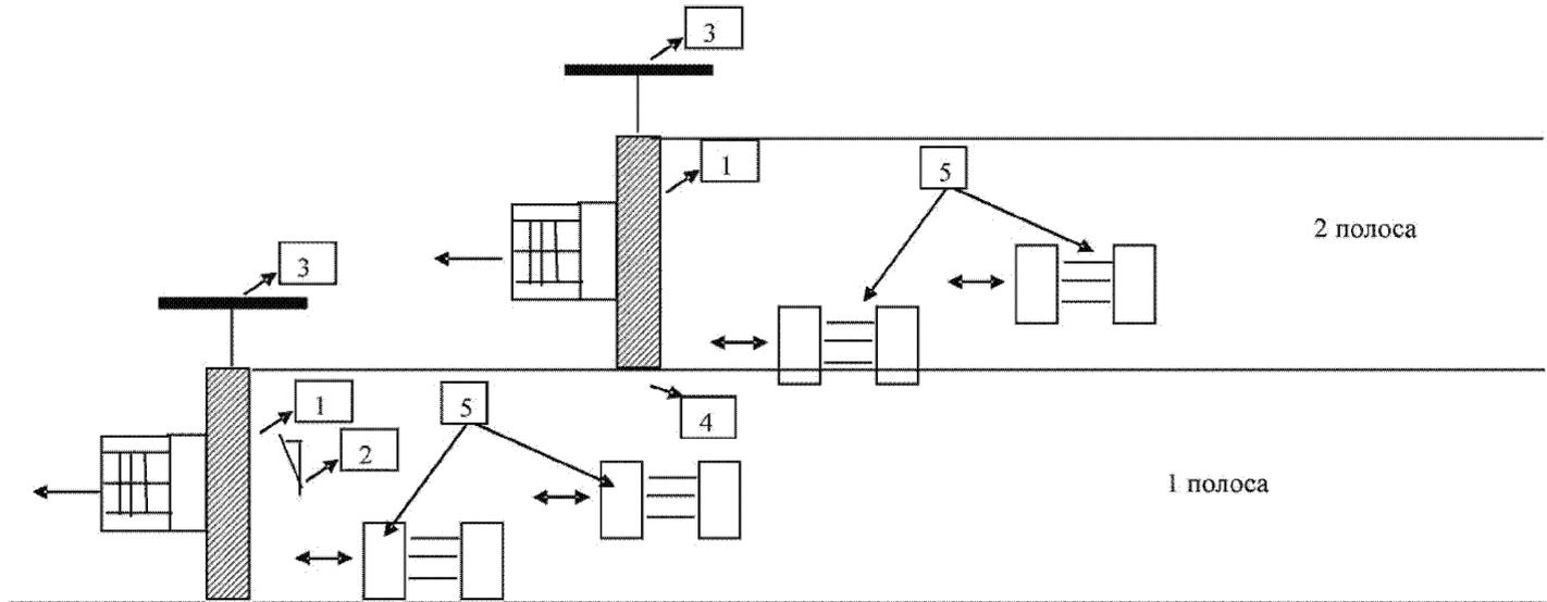
1 – асфальтоукладчик; 2 – датчик поперечного уклона; 3 – длинная лыжа; 4 – короткая лыжа (башмачок); 5 – катки
