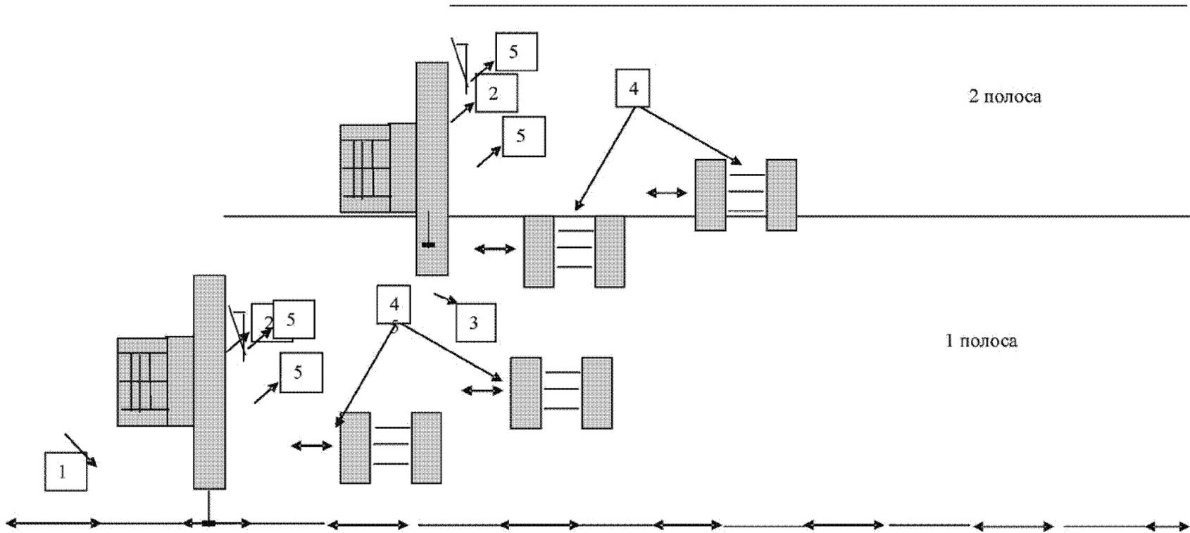
1 – копирная струна; 2 – асфальтоукладчик; 3 – короткая ложка (башмачок); 4 – гладковальцовые катки; 5 – датчик поперечного уклона
