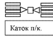
Рисунок Б.3 – Уплотнение покрытия по схеме «след в след»
