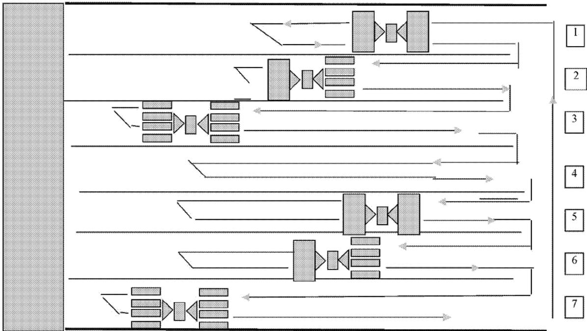
Рисунок Б.4 – Уплотнение покрытия по схеме «вразбежку»
