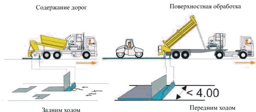
Рисунок 6.2 – Принципы работы машин для поверхностной обработки
