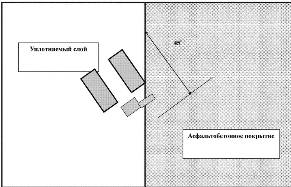
Рисунок Б.2 – Уплотнение поперечного сопряжения под углом
