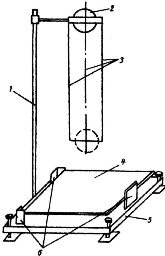
1 – стойка; 2 – металлический шар; 3 – направляющие; 4 – пластина; 5 – подставка; 6 – опоры
