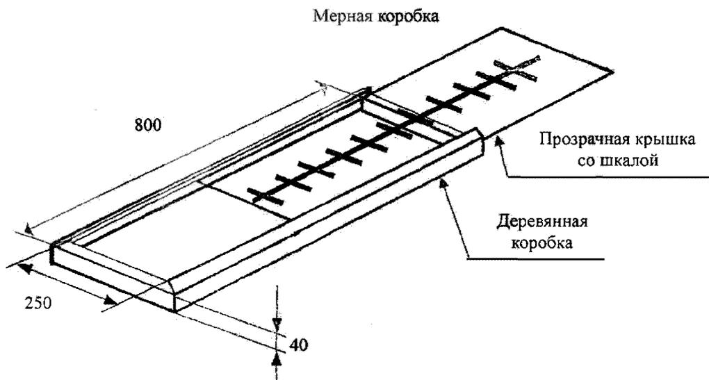
Рисунок М. 1 – Размеры мерной коробки (мм)
