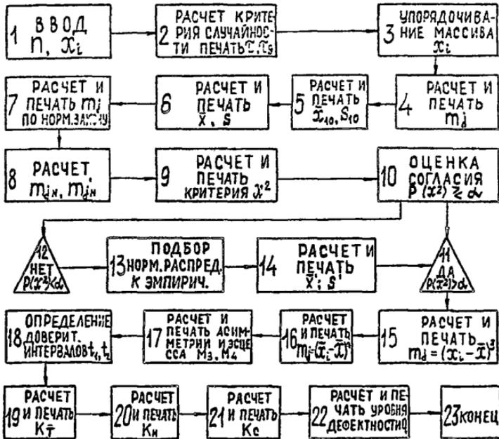
Блок-схема алгоритма расчета показателей точности и стабильности технологического процесса
