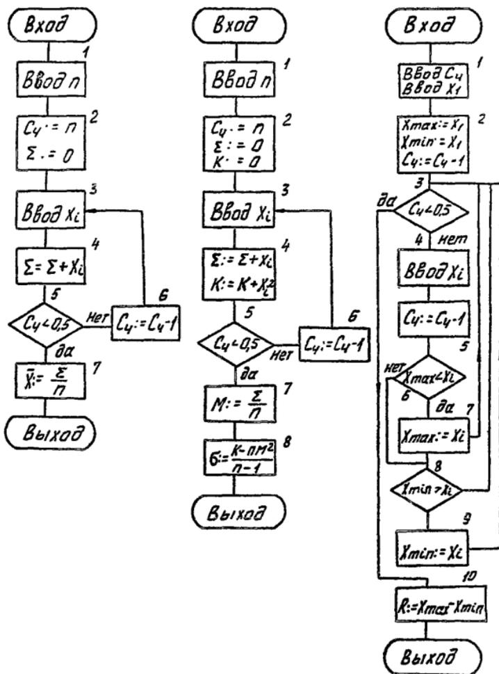
Блок-схема алгоритма расчета статистических характеристик на микро-ЭВМ
