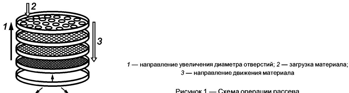
Рисунок 1 — Схема операции рассева
