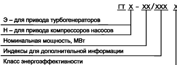
**П р и м е ч а н и е** — Индексы для дополнительной информации изготовитель может использовать для обозначения модификации газотурбинной установки.
