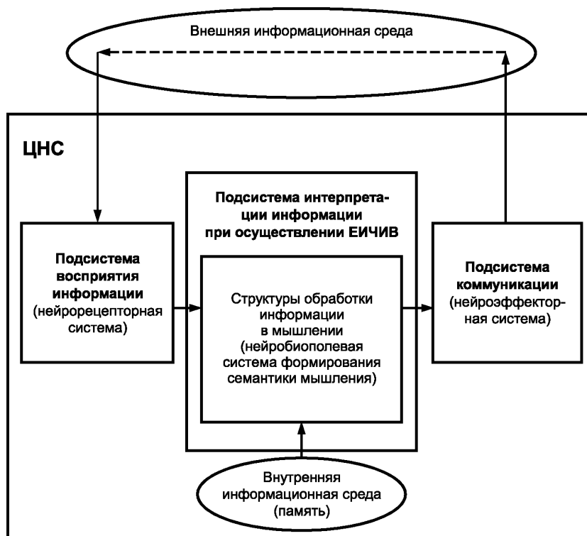
Рисунок 3 — Функциональная схема формирования семантики мышления оператора с образованием и осуществлением ЕИЧИВ при возникновении ИОП в ЦНС оператора
