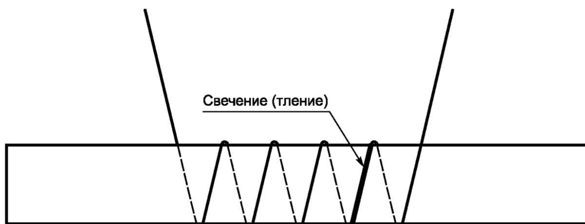
Рисунок С.8 — Наблюдается частичное или полное свечение (тление).
