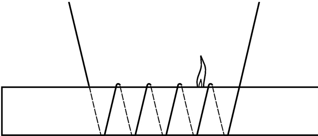
Рисунок С.4 — Воспламенение без сквозного проплавления.
