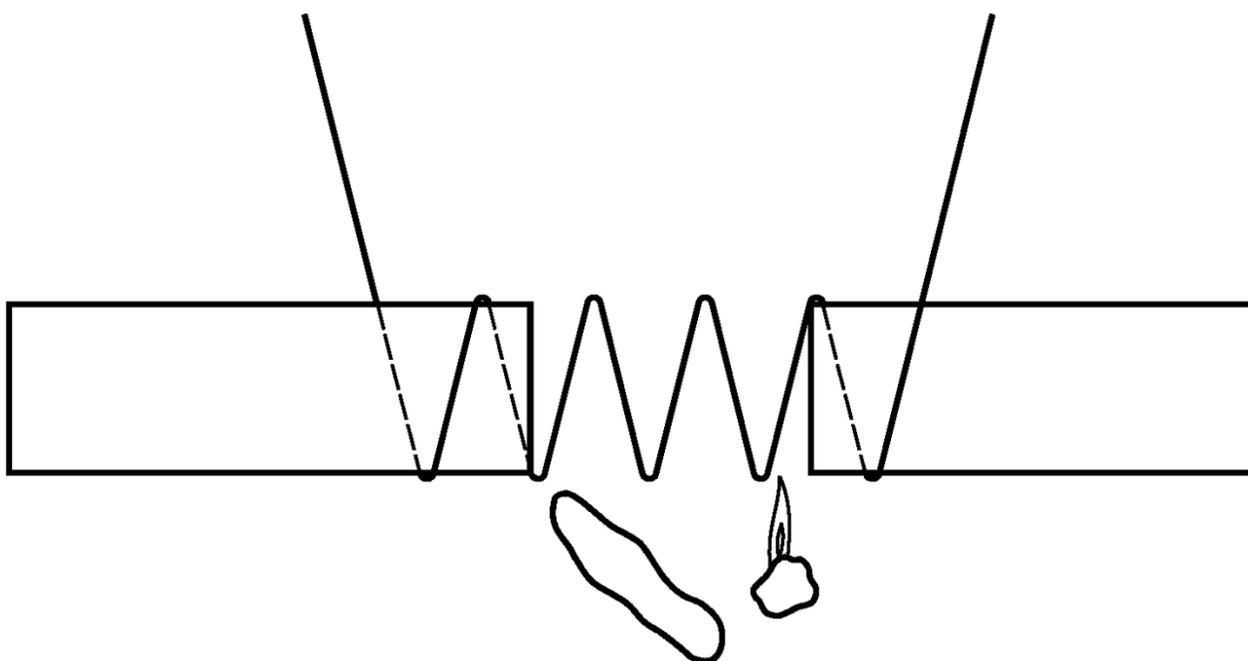
Рисунок С.6 — Воспламенение с частичным или полным сквозным проплавлением.
