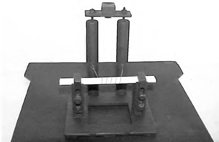
Рисунок 1 — Пример монтажа испытательного зажимного приспособления
