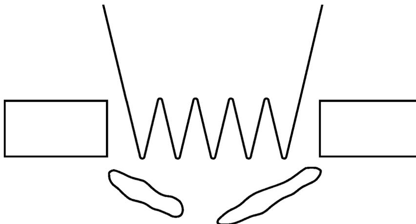
Рисунок С.2 — Сквозное проплавление без воспламенения.
