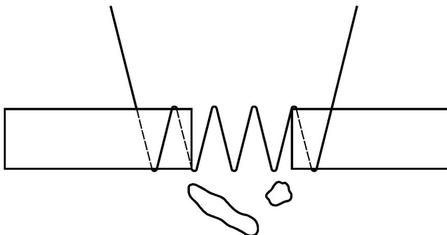
Рисунок С.3 — Частичное сквозное проплавление без воспламенения.
