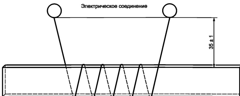
Рисунок 2 — Пример намотки проволоки на испытуемый образец
