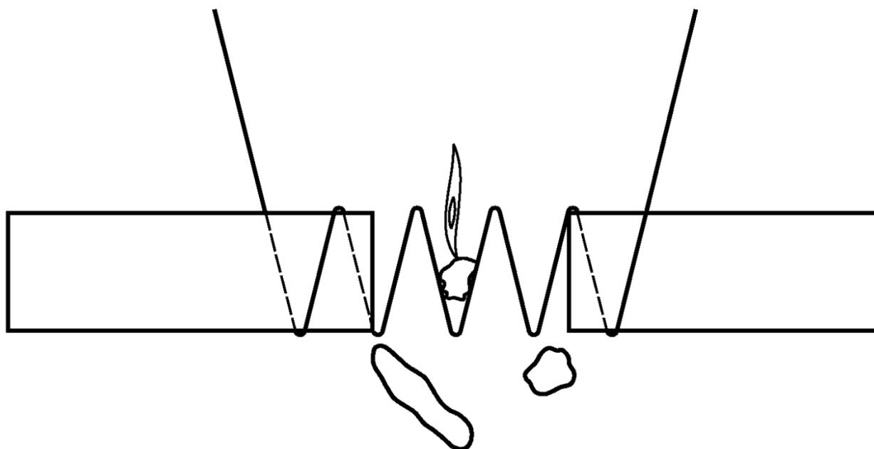
Рисунок С.7 — Воспламенение с частичным сквозным проплавлением.
