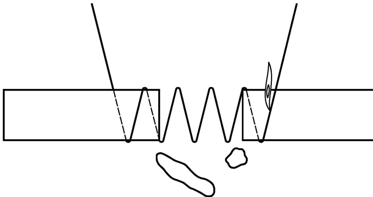
Рисунок С.5 — Воспламенение с частичным сквозным проплавлением.
