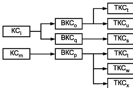
Рисунок 4 — Пример построения дерева событий (до ТКС)
