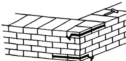
3 УСТАНОВКА И ЗАКРЕПЛЕНИЕ ПОРЯДОВКИ;  $K_1$  - 0,5 мин;  $K_2$  - 1 мин
