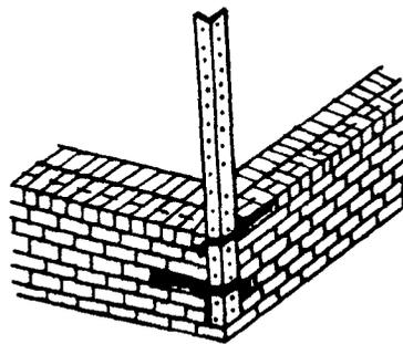
4, 5 ВЫВЕРКА ПОРЯДОВКИ, ЗАКРЕПЛЕНИЕ НА НЕЙ ОТВЕСА И НАТЯГИВАНИЕ ПРИЧАЛЬНОГО ШНУРА; 1,5 мин;  $K_1$ ,  $K_2$ ; отвес, причальный шнур
