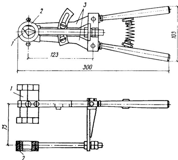
Рис. 5. Схема набона-приспособления для ультразвукового контроля тавровых соединений стержней с плоским элементом проката, выполненных сваркой под слоем флюса
