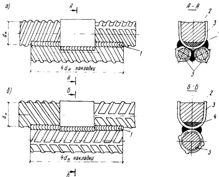
Рис. I2. Усиление дефектных горизонтальных соединений при установке двух накладок (а) и одной накладки (б)
