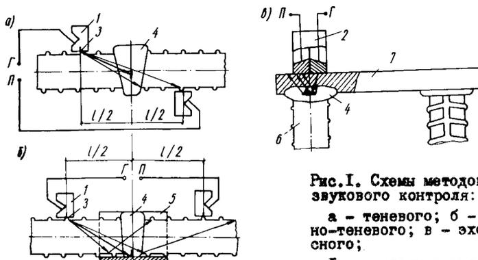
Рис. I. Схемы методов ультразвукового контроля:
