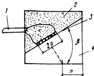
Рис.2. Конструкция наклонного преобразователя
