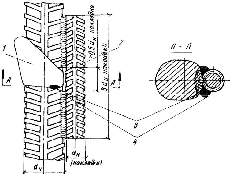
Рис. II. Усиление дефектных вертикальных соединений
