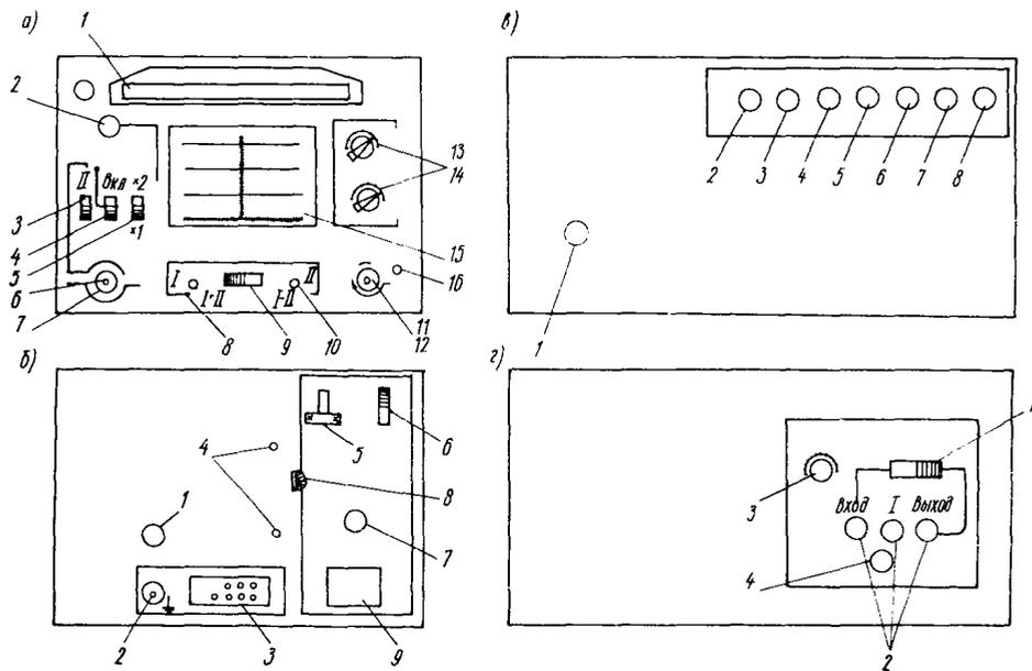
Рис.10. Схема органов управления дефектоскопа ДУК-66ПМ
