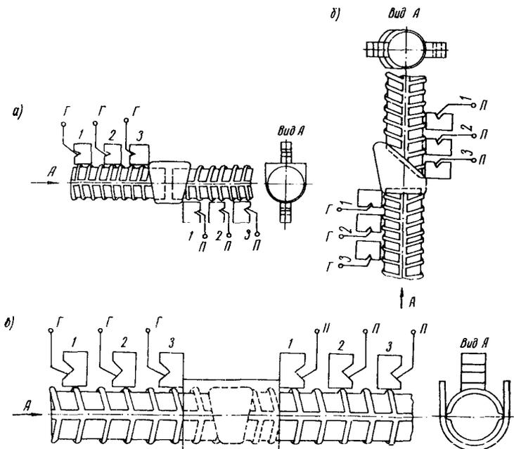
Рис.8. Схемы перемещения преобразователей при контроле сварных соединений аркатурных стержней, выполненных в инвентарной форме при горизонтальном (а) и вертикальном (б) положениях стержней и на скобах-накладках или подкладках (в)
