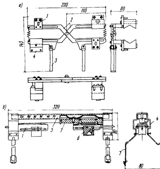
Рис.4. Схемы механических устройств для ультразвукового контроля стыковых соединений стержней, выполненных ванной сваркой в инвентарной форме (а) и ванно-шовной сваркой на остающейся скобе-накладке или подкладке (б)
