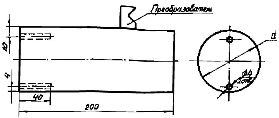
Рис. 2. Стандартный образец для настройки ультразвукового прибора при НК штрелов;
