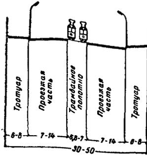
Рис. 8. Поперечный профиль магистральной улицы общего городского и районного значения с трамвайными путями
