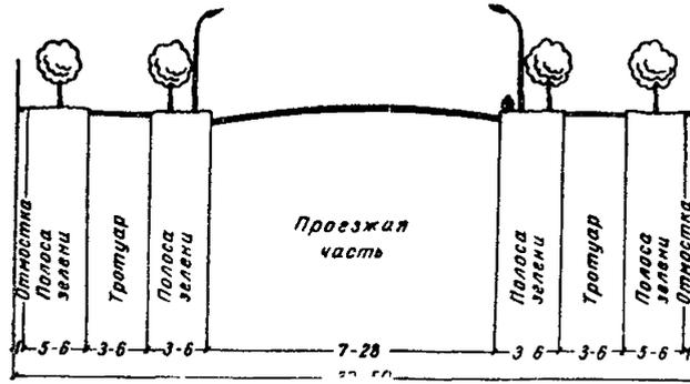
Рис 5 Поперечный профиль магистральной улицы общегородского и районного значения без трамвайных путей
