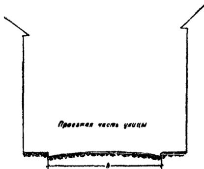
Рис 1 Наиболее распространенный профиль улицы
