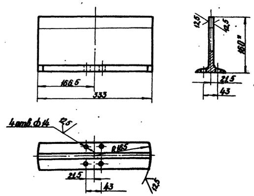
1. Предельные отклонения размеров: отверстий Н14, валов h14, остальных  $\pm \frac{IT14}{2}$ .
