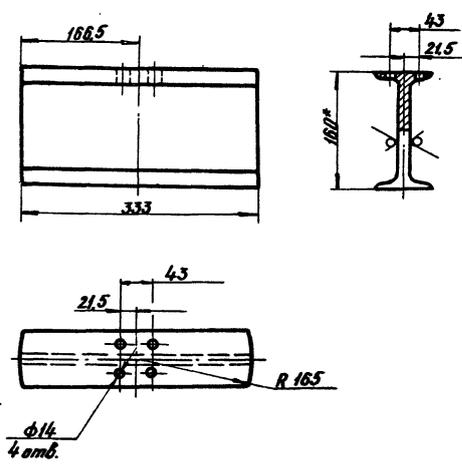
1. Предельные отклонения размеров: отверстий Н14, валов h14, остальных  $\pm \frac{IT14}{2}$ .
