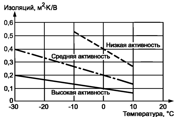
Рисунок В.1 — Требования изоляции перчатки при трех уровнях физической активности
