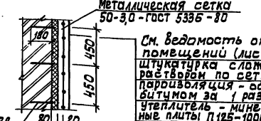
Деталь крепления утеплителя к кирпичной стене
