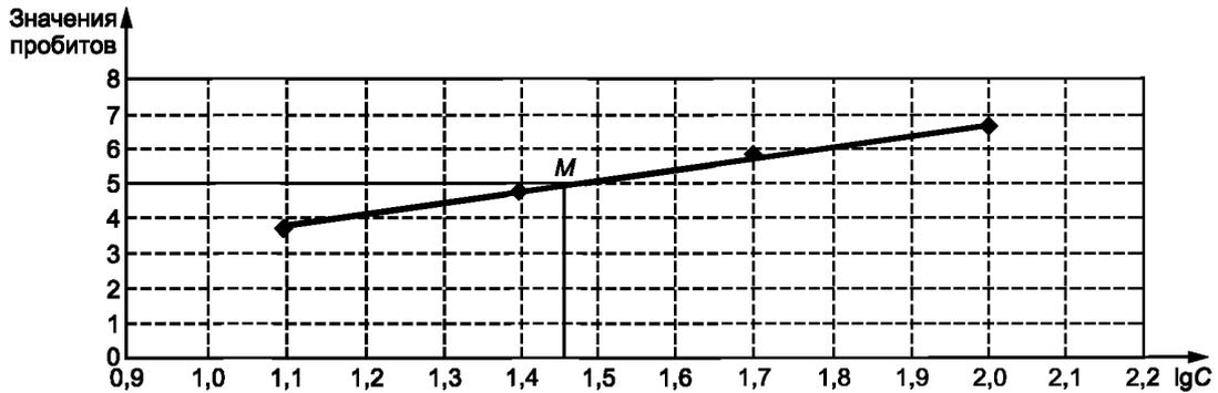
Рисунок ДБ.1 — График линейной зависимости значений пробитов от  $\lg C$  анализируемой пробы сточной воды
