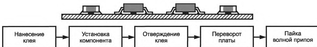
Рисунок 2 — Односторонний печатный узел. Пайка только погружением
