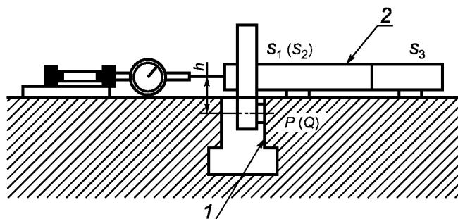
1 — измеряемая поверхность; 2 — измерительное приспособление (см. рисунок 27)
