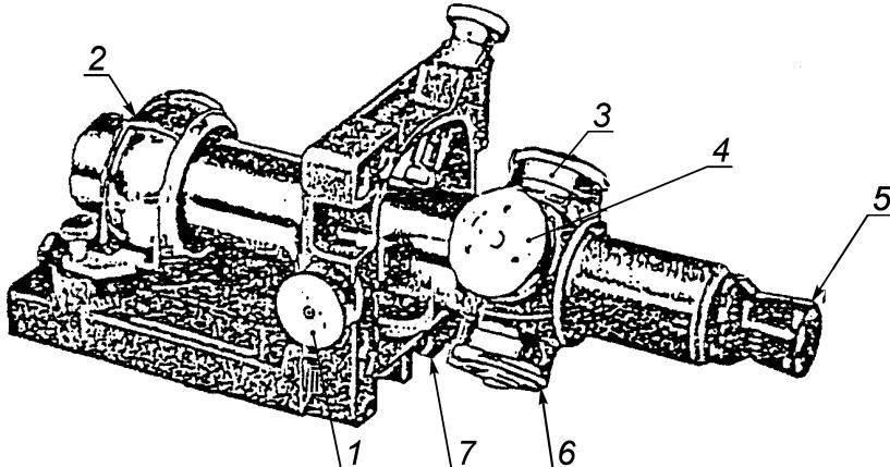
1 — регулятор боковой настройки; 2 — сферическая цапфа; 3 и 6 — микрометрический лимб; 4 — настройка на фокус; 5 — окуляр; 7 — регулятор вертикальной настойки
