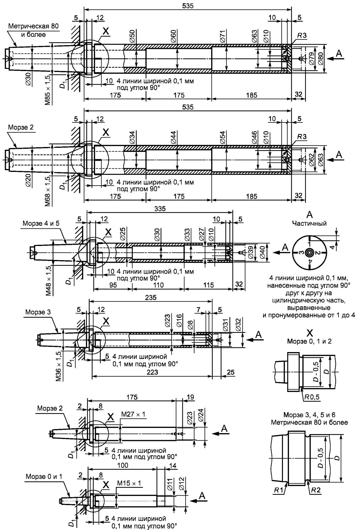
Рисунок А.3 — Оправки контрольные с коническим хвостовиком
