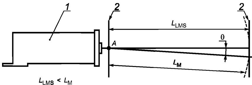
1 — лазерный интерферометр; 2 — отражатель (рефлектор) с плоским зеркалом
