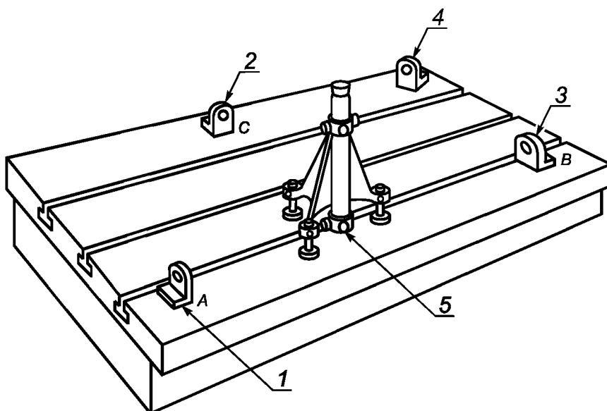
1, 2, 3 — А, В, С — базовые визирные марки; 4 — переставляемая четвертая визирная марка (измерительная); 5 — вращающийся оптический угольник
