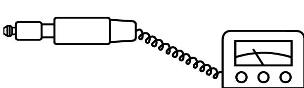
Рисунок А.11 — Датчик с измерительным наконечником осевого действия
