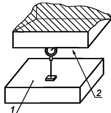
1 — поверочная плита (база отсчета); 2 — измеряемая плоскость
