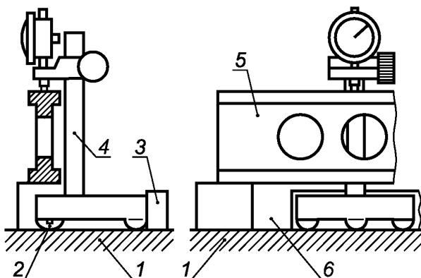
1 — контролируемая поверхность; 2 — контактные точки на линии (плоскости), перпендикулярной к конечнику; 3 — направляющая линейка; 4 — стойка для крепления индикатора; 5 — поверочная линейка; 6 — опоры для поверочной линейки
