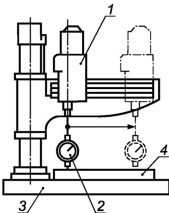
1 — перемещаемый элемент станка; 2 — измерительный прибор;
