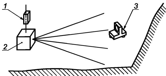
1 — источник лазерного излучения; 2 — сканирующий модуль;
