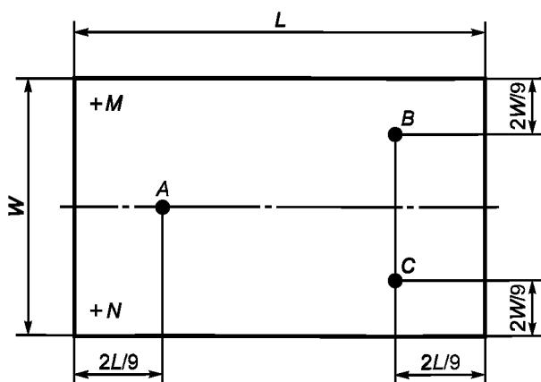
*A, B, C — базовые опоры поверочной плиты, обеспечивающие минимальный прогиб под собственным весом;
