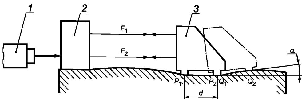
1 — источник лазерного излучения; 2 — интерферометр; 3 — перемещаемый элемент
