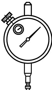
Рисунок А.9 — Индикатор часового типа осевого действия
