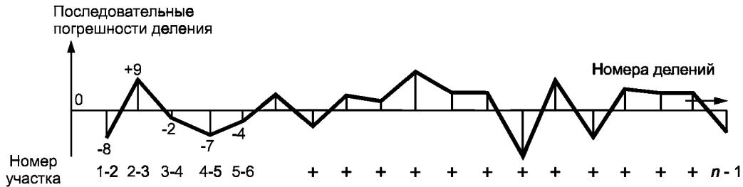
Рисунок 107 — Последовательная погрешность деления градуированной шкалы, показанной на рисунке 105
