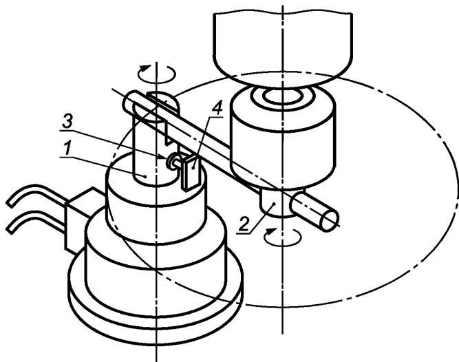
1 — специальное поворотное приспособление № 1; 2 — специальное поворотное приспособление № 2; 3 — однокоординатный датчик; 4 — визирная марка; 5 — провода для подсоединения к компьютеру
