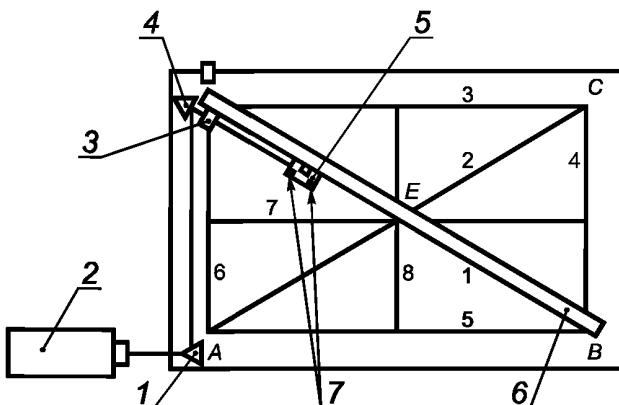
1 — первое поворотное зеркало; 2 — лазерная головка;
