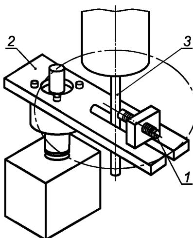
1 — однокоординатный датчик; 2 — специальное поворотное приспособление; 3 — контрольная оправка
