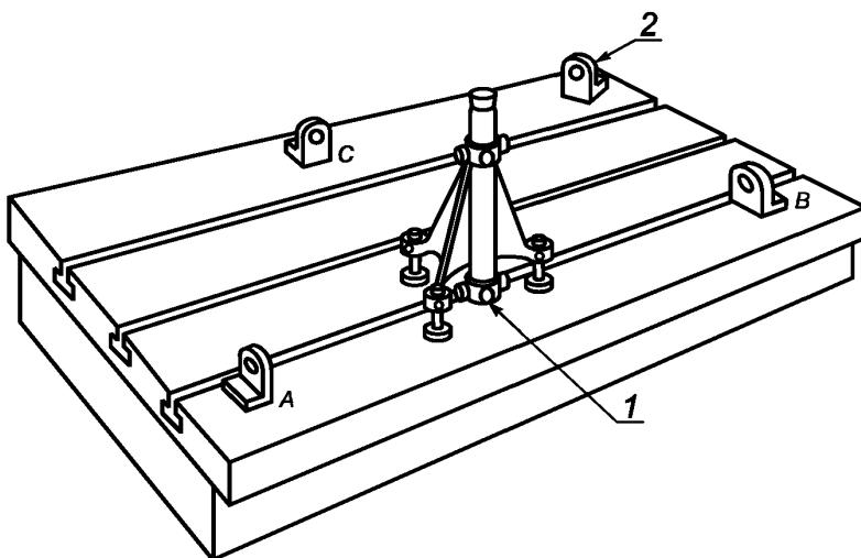
1 — поворачиваемый оптический угольник; 2 — четвертая метка
