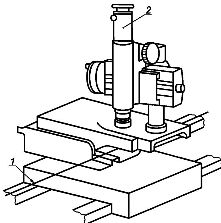
*1 — натянутая струна; 2 — микроскоп*
