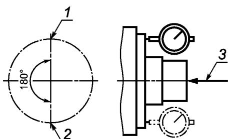
1, 2 — позиции установки измерительных приборов; 3 — осевая нагрузка
