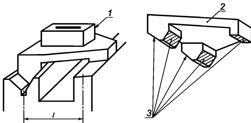
1 — уровень; 2 — перемещаемое приспособление; 3 — контактные поверхности перемещаемого приспособления
