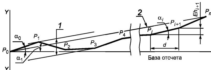
1 — отклонение от прямолинейности; 2 — расчетная линия
