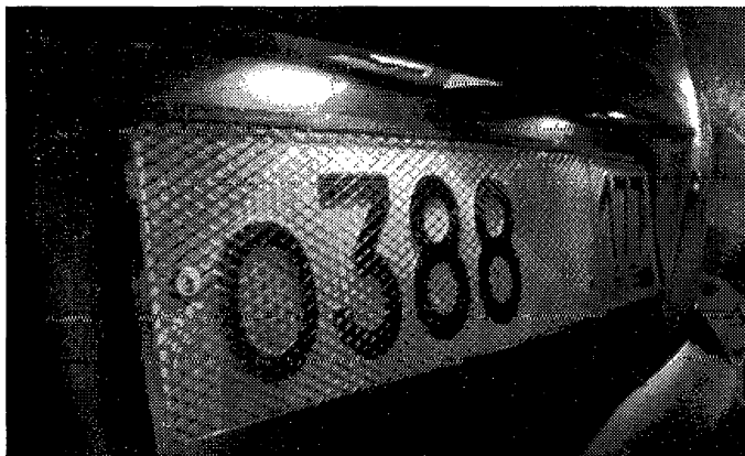
Рис. П9 - Нанесение специальной сетки на номер для дезориентации СОР
