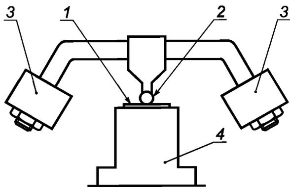
1 — испытуемый образец; 2 — опорный шарик; 3 — груз;
