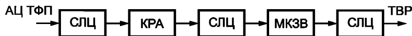
Рисунок 2 — Тркт первичного распределения программ звукового вещания с оптоволоконными и кабельными системами передачи
