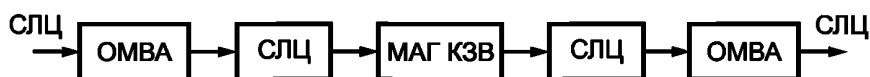
Рисунок 6 — Междугородний канал звукового вещания с оптоволоконными и кабельными системами передачи в магистральном канале звукового вещания
