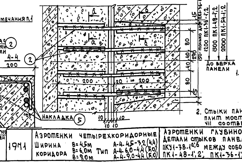
ДЕТАЛЬ СТЫКА ВЕРХНЕЙ КРОМКИ ПАНЕЛЕЙ.
