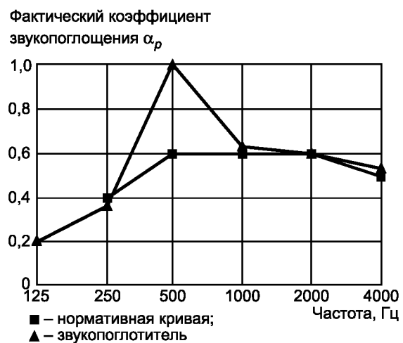
Рисунок В.4 — Пример определения индекса звукопоглощения с применением индикатора формы \alpha_w [\alpha_w = 0,60 (M)]
