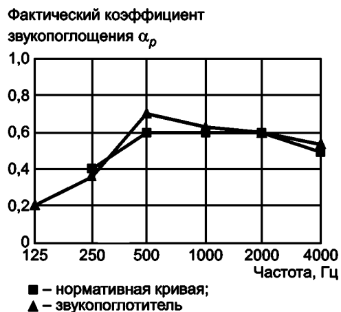
Рисунок В.3 — Пример определения индекса звукопоглощения \alpha_w ( \alpha_w = 0,60 )
