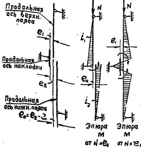
Эпюры М строятся для двухпролетной системы, при этом для случая  $N e_1$ , принимается равномерное распределение момента по длине накладки в каждой ее половине.
